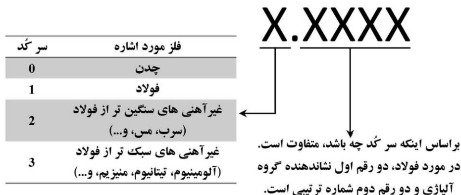
شکل ۶: ساختار عمومی سیستم شماره گذاری فولاد
